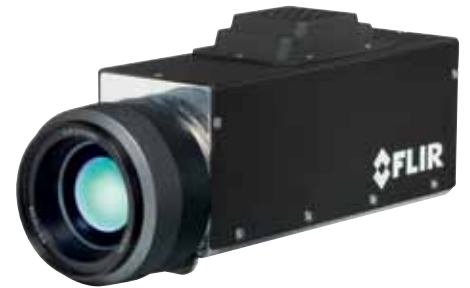
FLIR G300a 광학적 가스 카메라는 냉각식 안티몬화 인듐 (Indium Antimonide; InSb) 디텍터를 사용하여 320 x 240 픽셀의 고품질 이미지를 제공합니다.
