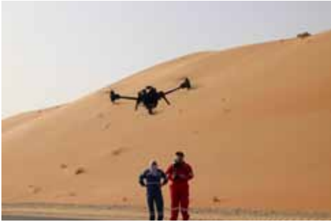
다니엘 셀스렛트(Sky Eye Innovations): 검사원은 지상에서 조이스틱과 조종사용 화면을 통해 드론에 탑재되어 있는 카메라를 안전하게 조종할 수 있습니다.
