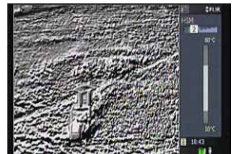
무인항공기(UAV) 드론에 FLIR G300a 카메라를 탑재하고 시험 비행을 실시한 결과, 지상에 있는 가스 용기에서 누출되고 있는 가스를 발견했습니다. 위의 사진은 열화상이며 아래 사진은 HSM 모드로 촬영한 사진입니다.
